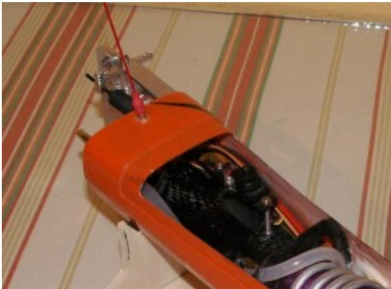
Nun da auch dieser Schritt zu Ende gebracht war, montierte ich den Wasserkühlungseingang. Diesen habe ich aus einem gebogenen Messingrohr hergestellt, der in Richtung des Rustertails gestellt wurde. Das benötigte Wasser wird von der Schiffsschraube in das Kühlsystem geworfen.
