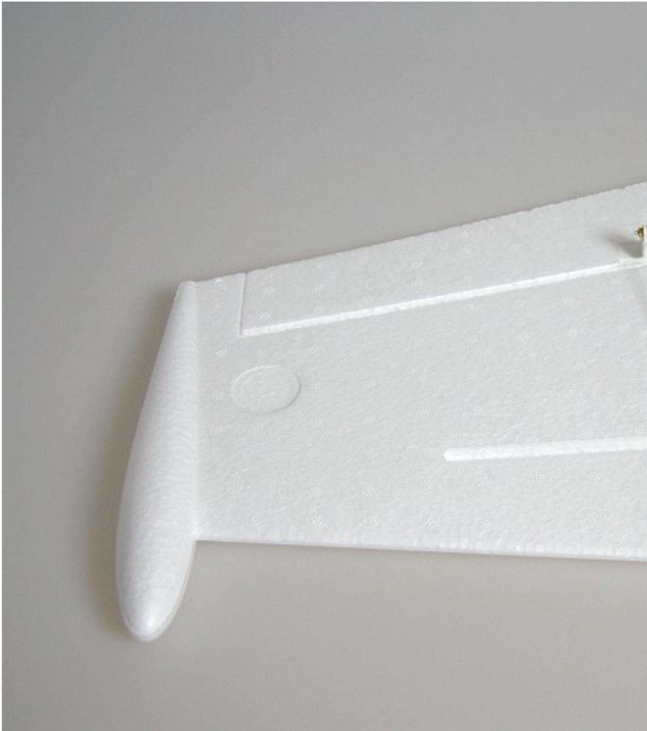
... die Hitec Servos HS-55 passen genau in den Servoschacht
