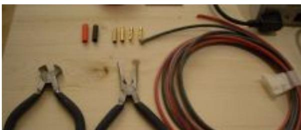
Als Halterung für die Goldstecker verwende ich einen Balsaklotz indem ich passende Größen für 4,00mm und 3,5mm Goldstecker gebohrt habe. Der Vorteil bei Holz ist dass die Wärme nicht so schnell abgeleitet wird und der Lötvorgang schneller erledigt ist. Generell sollte man schnell löten. Zuviel Hitze schadet dem Material und kann elektronische Bauteile oder Akkus überhitzen und dadurch Defekte verursachen.
