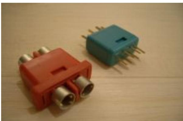
Die Kontaktstellen mit Schmirgel etwas aufrauen, dann hält das Lot sicher. Nun die Pins verzinnen, in diesem Fall die Servokabel. Beides zusammen halten und kurz erhitzen - fertig! Auf den Bildern seht ihr die Servoverbindung der Flächen für meinen Ion. Mit einem Stecker wird das Querruder und die Wölbklappen mit dem Empfänger verbunden.Â
