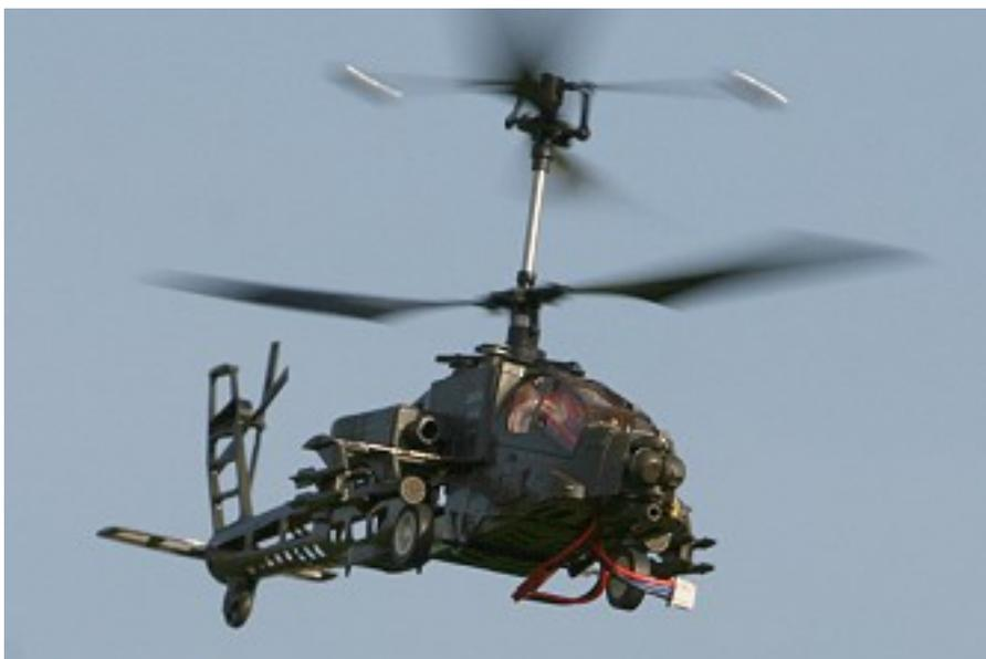
Bei meinen ersten Testflügen im Spätsommer 2007 konnte ich immer wieder kurze Ausfälle des Reglers im Flug feststellen, die Drehzahl viel spontan ab und der Heli verlor sofort an Höhe. Auffallend war nach einer ersten Kontrolle eine enorme Stauwärme in der Cockpitsektion - der Regler kommt förmlich ins Schwitzen. Bei vielen Koaxial-Heli-Modellen sitzt der Akku in einer Akkuhalterung
