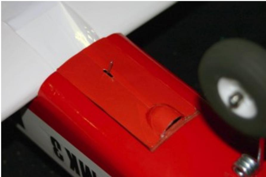
Um den Regler mit Kühlluft zu versorgen bekam die Haube eine Ansaughutze und die Flächenaussparung im Bereich der Nasenleiste, welche eigentlich durch einen beiliegenden fertig bebügelten Balsaklotz verschlossen wird, wurde zum Abführen der Luft verwendet. Dazu wurde aus Balsabrettchen und weißer Bügelfolie ein Ableitungskanal angefertigt.
