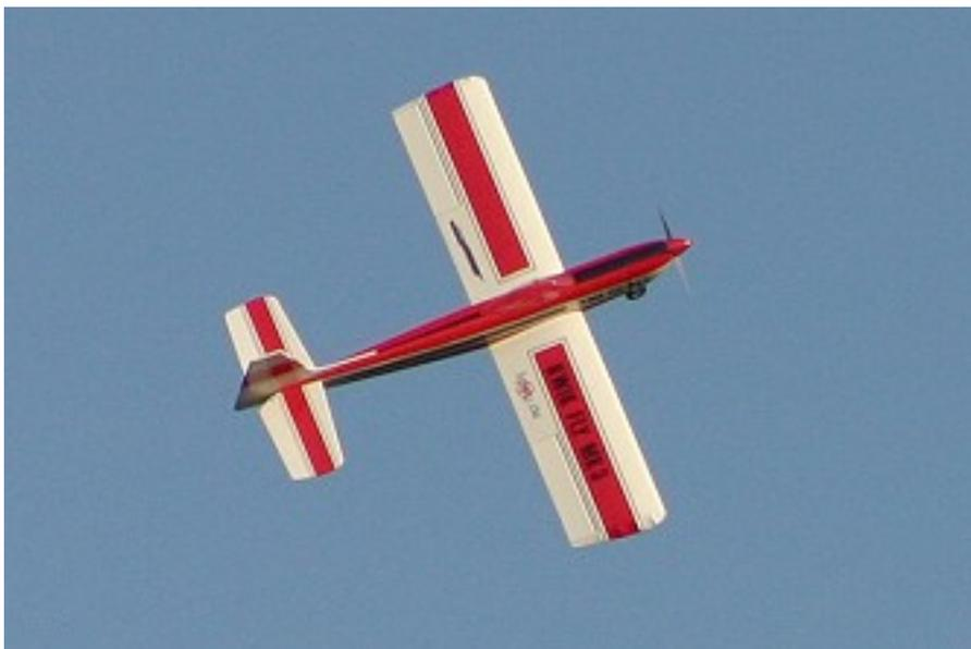
Die Flugzeiten sind mit dem 3650 Lipo mehr als ausreichend. Der maximale Strom ist mit ca. 30 A in einem sicheren Bereich und der YGE Regler hat auch bei Teillastflügen keine Probleme. Halbgas reicht für Rundflüge vollkommen aus, lediglich für Figuren muss Gas gegeben werden. Somit ist ein 6 minütiger Flug mit Restreserven kein Problem.
