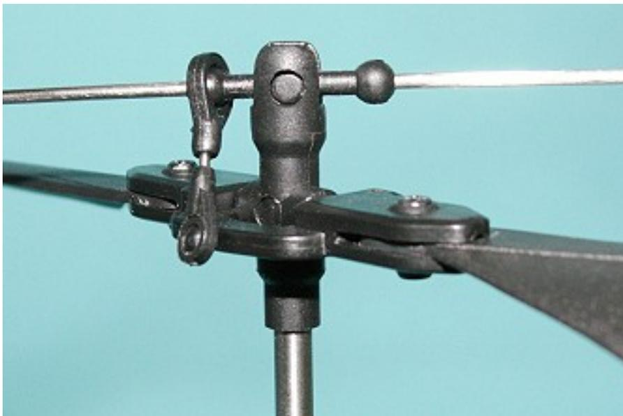
... hier zu sehen die obere Rotorwelleneinheit mit der Stabilisierungsstange - umgesetzt wurden einklappbare Rotorblätter, die im Flugbetrieb für Anfänger von Vorteil sind
