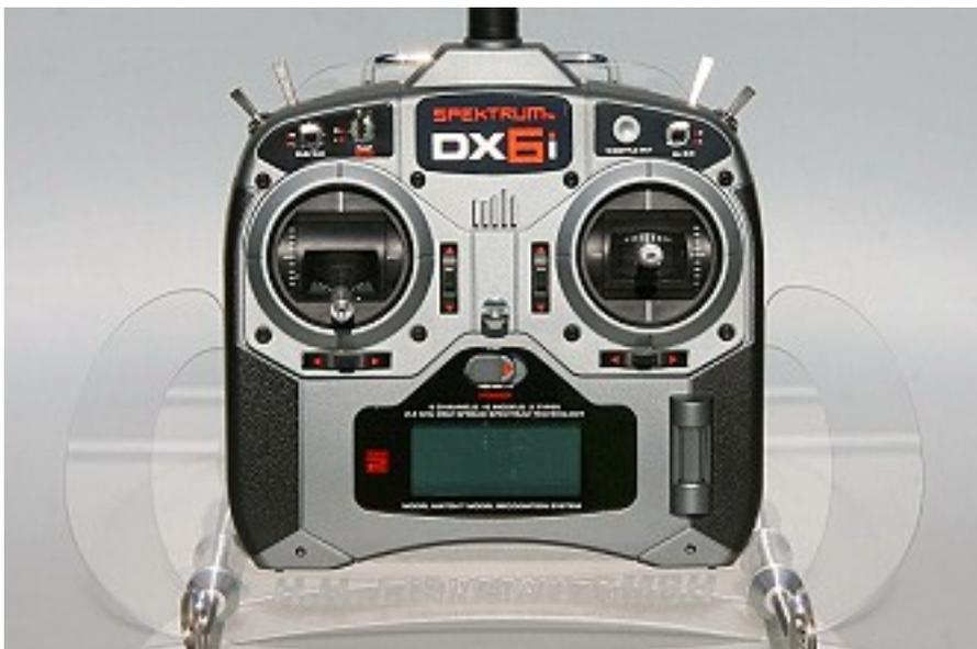
Der DX6i Sender ist auch für den Lehrer/Schüler Betrieb vorgesehen. Über den Trainerschalter lässt sich dieser Modus aktivieren. Eine entsprechende Buchse für die Verbindung des Lehrer/Schüler Kabels, befindet sich rückwärtig am Sender. Als Schülersender muss jedoch eine zweite Anlage mit gleicher Programmierung vorliegen. Mit einem Modellspeicher von 10 Modellen, kann diese Anlage auch für weitere Heli- und Flächenflieger genutzt werden. Somit
