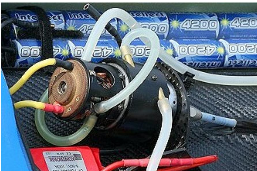
Bei mir kommt ein Plettenbergmotor der Größe 355/30/4 zum Einsatz. Diesen kann man günstig im Netz erstehen und in Zusammenarbeit mit einem passenden Bürstenregler, sollte dieses Antriebset auch die günstigste aller Möglichkeiten darstellen. Zur Kraftübertragung von Motor zur Welle ist eine Spannzangenkupplung verbaut. **Â Das erste Gasgeben**
