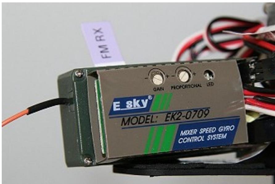
**Ä** Ein vorgesetzter Flansch auf der Kunststoffplatte übernimmt die Aufnahme und Fixierung der 4 – 1 Anlage (EK2-0709 Mixer Speed Gyro Control System). Die LED-Leuchte der 4 – 1 Einheit signalisiert eine abgeschlossene Initialisierung mit grün. Für eine schnelle Umsetzung der Steuerbefehle kommen zwei Digital-Servos zum Einsatz. **Ä Der Erstflug Ä** Nach der Entnahme aus der Verkaufspackung und dem ersten Ladegang des mitgelieferten Lipo-Akku, wird
