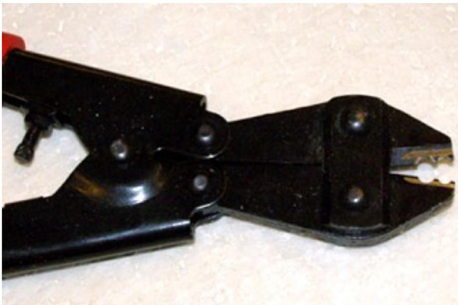
Â Erhältlich ist diese Zange als Set mit Seil und Presshülsen in den Maßstäben 1:4 und 1:3 bei Balsa USA, in Deutschland vertrieben von [www.fun-modellbau.de](http://www.fun-modellbau.de) . Die damit hergestellten Pressstellen sind festigkeitsmäßig über jeden Zweifel erhaben und sehen zudem noch original aus. Â
