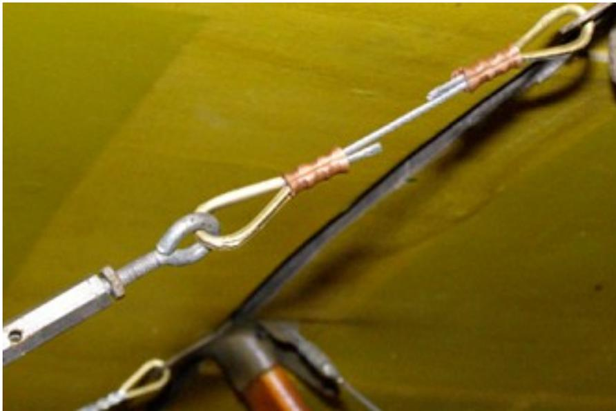
Â Zur Vermeidung von Schwingen und Knackimpulsen werden beieinanderliegende Seile mit Kupferlackdraht umwickelt und gesichert: Â
