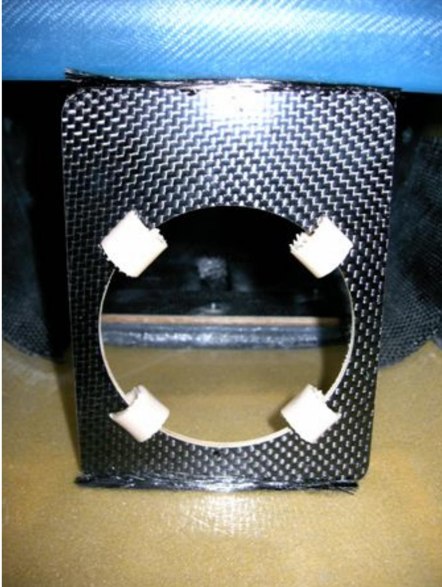
Hier ist der Spant für das DPSI, Akkus und Servos zu sehen:
