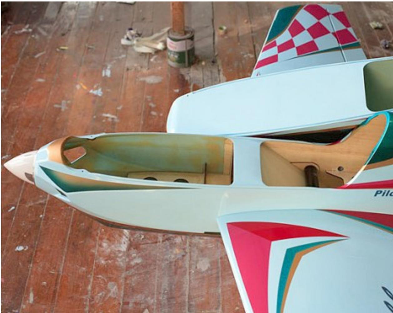
Die Spannweite des neuen Modell liegt bei 1,92m, die Rumpflänge bei ca. 2,0m. Das Gewicht wird sich sicherlich -je nach verwendetem Akkutyp und Kapazität- bei ca. 4,8kg einpendeln.
