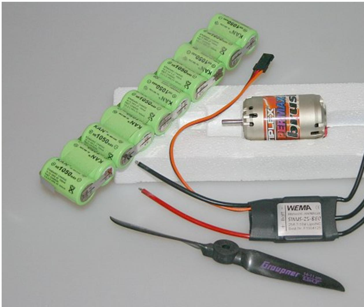
Bei der Motorisierung mit normalen Lithium-Zellen, erreichten wir bei Messungen mehr als 29 A Stromstärke und kamen somit für den Regler, Akku und dem Motor in einen bedenklichen Grenzbereich. Beim fünften Testflug platze eine Akkuzelle. Der Akku wurde daraufhin durch einen LiPO-Akku ersetzt (LEMONRC 2250-11.1 V). Ebenso haben wir eine kleinere Luftschraube montiert (4.75 x 4) und kamen bei einer neuen Messung unter einer Stromstärke von 25 A
