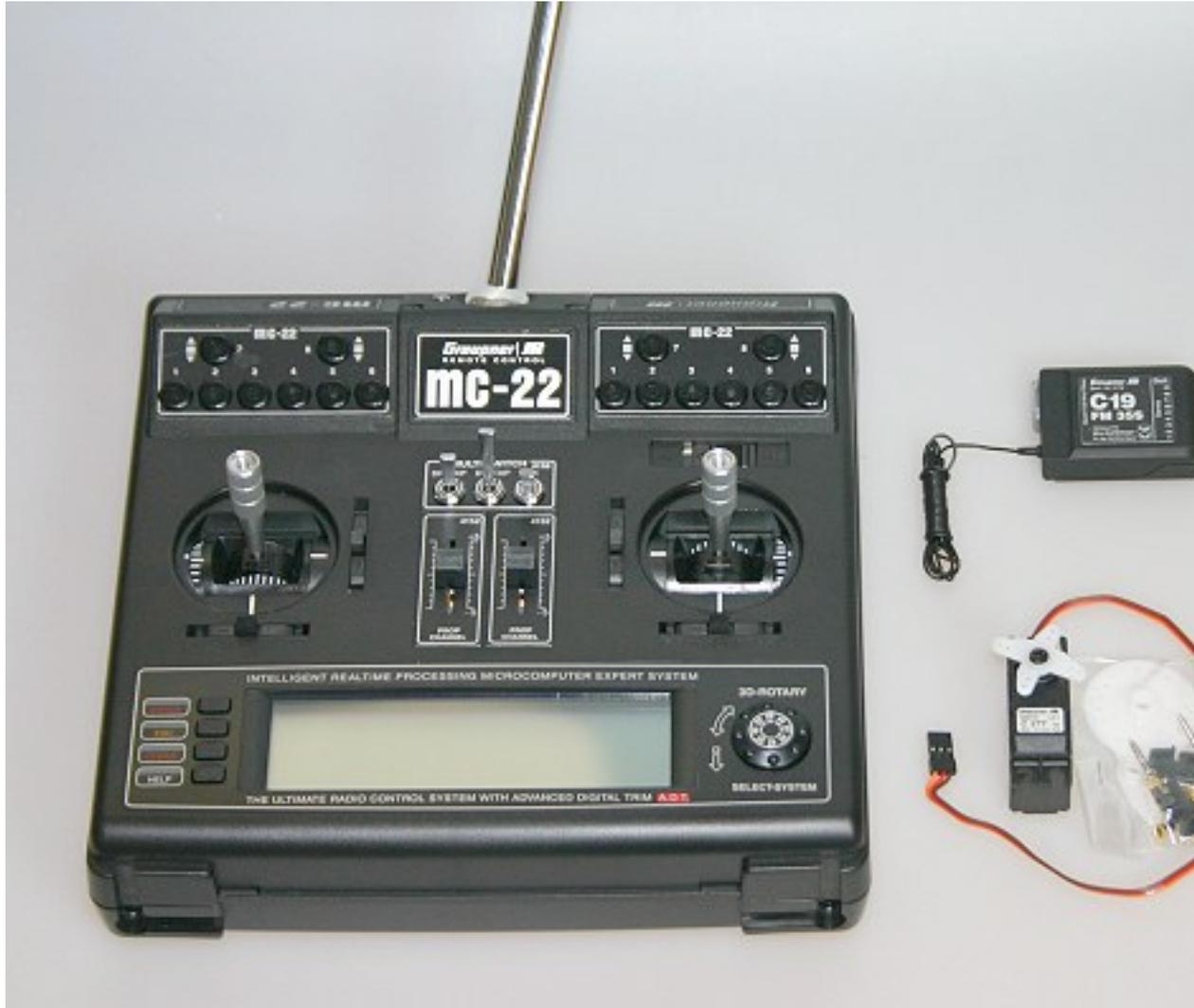
**Lieferumfang Komplettsset:** Fernsteuerung mc-22, Ein- u. Ausschalter zum Einbau in ein Modell, Empfänger C19, Servo C577, diverse Kleinteile für Servo und Sender, Bedienungsanleitung
