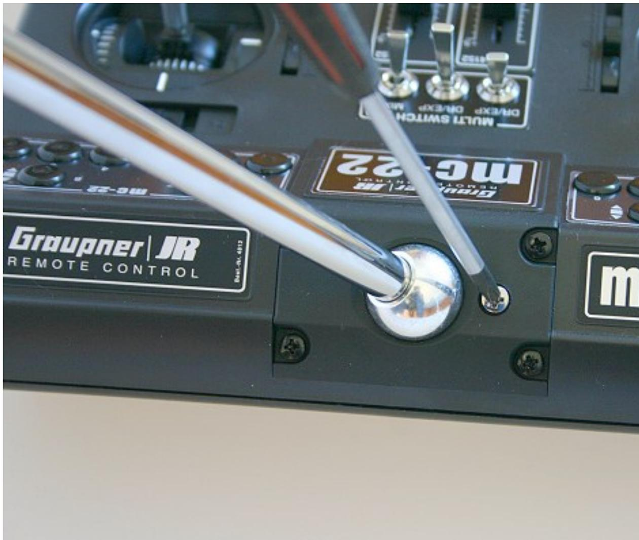
Die zehnteilige Teleskopantenne wird in das Kugelgelenkanschlussstück eingeschraubt und kann mechanisch ausgerichtet werden. Zum Ausrichten und Justierung wird einfach die Kreuzschlitzschraube gelöst.
