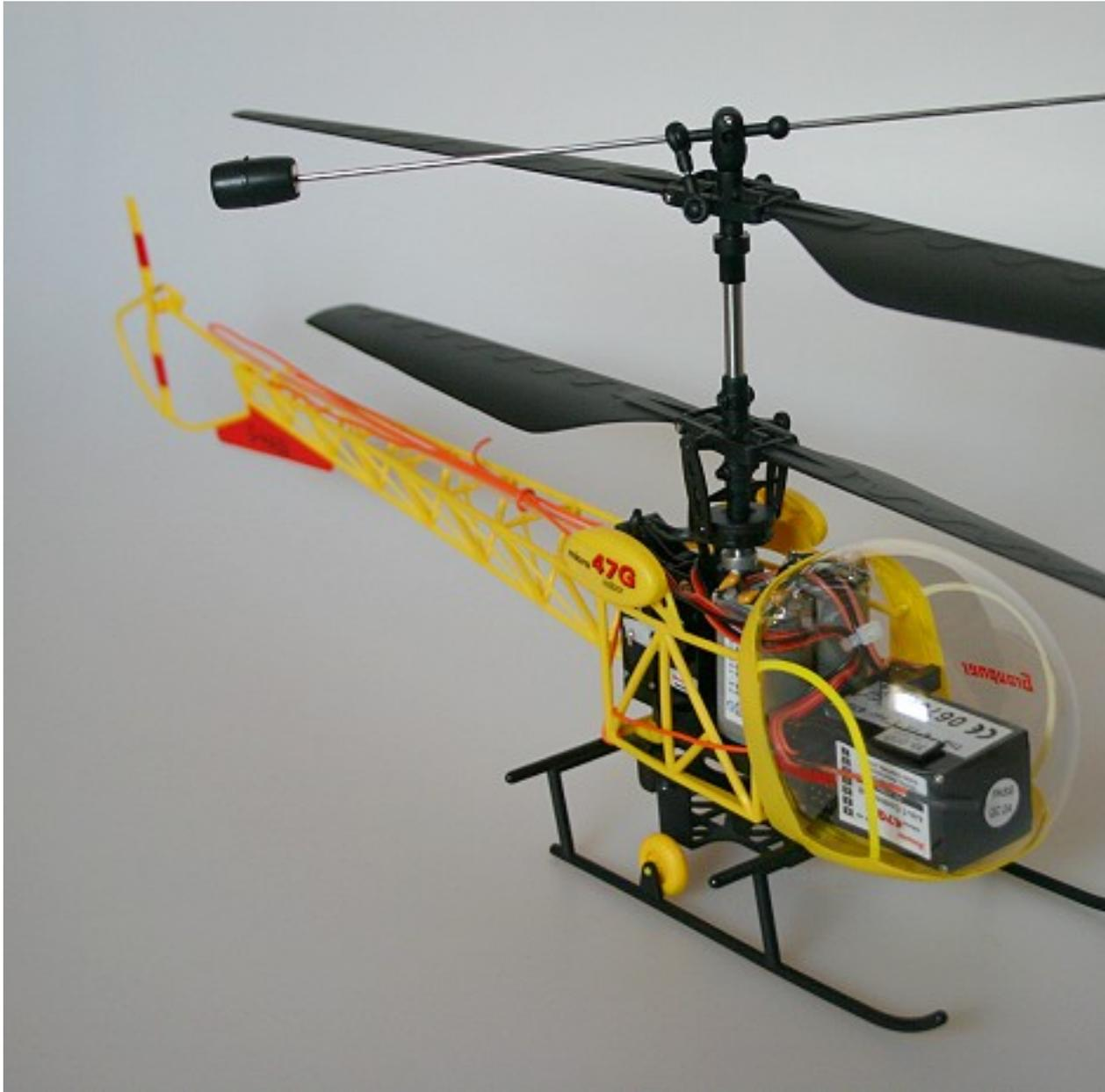
Etwas schmaler im Kufenbereich und eine andere Motorenanordnung prägen die Version 2006, des micro 47G ...
