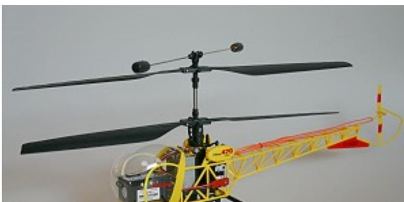
Ä **Die neue Version:** Ä Die 2006er-Version des micro 47G zeichnet sich in der schlankeren Kontur im Kufenbereich aus. Die Anordnung und Platzierung der beiden ElektromotorenÄ findet sich nun direkt vor derÄ Rotorwelle wieder.Ä Die Kabinenhaube ist nun erstmalig einteilig gefertigt. Ä Ä
