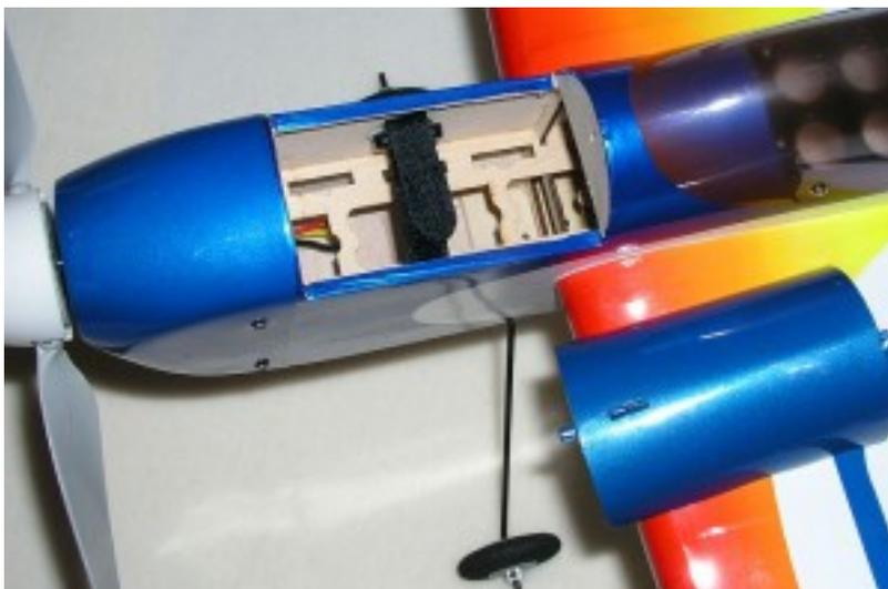
Alle RC-Komponenten im Rumpf sind durch eine Klappe am Rumpfboden bequem zu erreichen und der Akku kann durch eine Klappe im vorderen Bereich des Rumpfrückens leicht und schnell gewechselt werden. Diese Klappe ist durch einen Schnellverschluss leicht zu öffnen und der Akku kann dadurch ohne Herumdrehen des Modells gewechselt werden.
