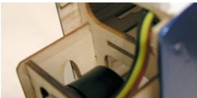
Motor- und Kabinenhaube sind mit je 4 Schrauben befestigt. Die Löcher dafür sind bereits in den tiefgezogenen Hauben vorgebohrt. Am Rumpf sind die Bereiche, in die die Schrauben kommen aufgedoppelt und somit ausreichend für die Schrauben verstärkt. Viel Liebe zum Detail.
