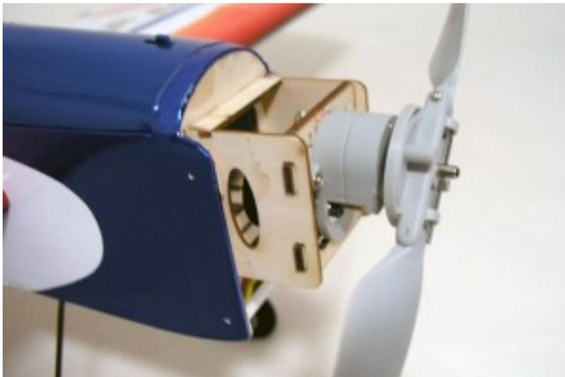
Der Spinner hat einen integrierten Blatthalter und ein Stahlstift dient als Mitnehmer für die Getriebewelle. Die Dimensionierung der Luftschraube und des Spinners passen optisch sehr schön zum Gesamtbild des Modells. Die Kabinenhaube wird nun aufgeschraubt. Interessant finde ich den Luftauslass an der Kabinenhaube, der die durch die Motorhaube einströmende Luft austreten lässt. Die Luft strömt an Motor, Akku und Regler vorbei. Wie gesagt, alles ist gut durchdacht.
