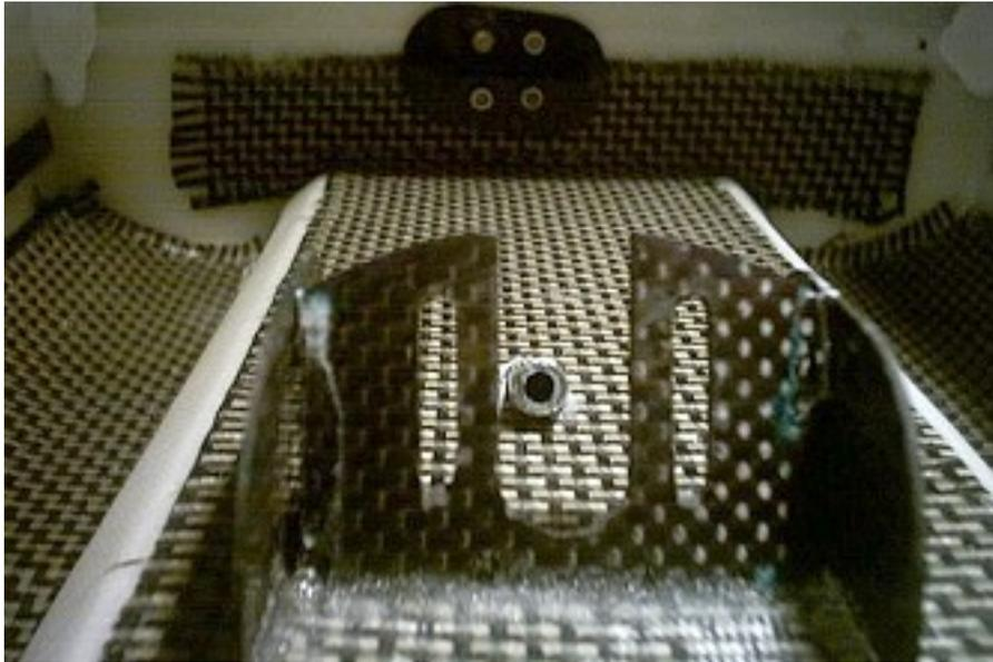
Zum Kleben nehme ich Sekundenkleber, wenn alles nach Abschluss fertig ist, wird dann mit CFK -Rovings die Festigkeit hergestellt.
