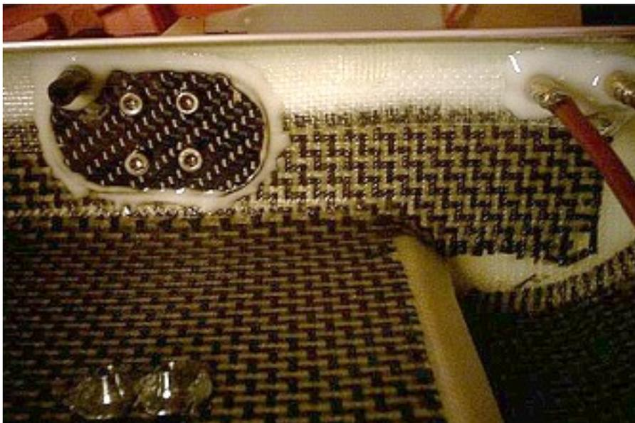
Jetzt nur noch den Strut im rechten Winkel montieren. Zur Befestigung des Strut´s wurde noch ein CFK- Platte gefräst in der auch die die Rudergestänge Durchführung gehalten wird.
