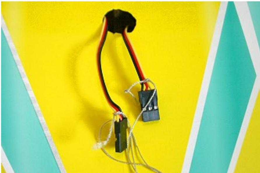
Fäden als Einzieh-Hilfe für das Servokabel
